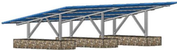
Figure 8: Plan de principe d'une table (Vue ISO) (Source : AKUO ENERGY OCEAN INDIEN)
