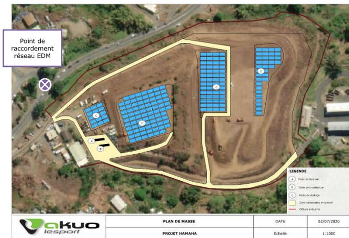
**Figure 19 :** Localisation du poste de raccordement pressenti sur la ligne HTA du réseau local nécessitant un raccordement souterrain depuis le PdL de la centrale photovoltaïque (localisation à confirmer, en attente du retour de la PRAC)
